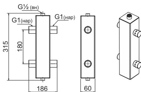
Гидроделитель универсальный вертикальный, 2 контура
