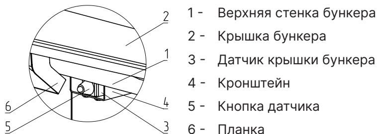
Рис.16 Установка датчика крышки бункера.
