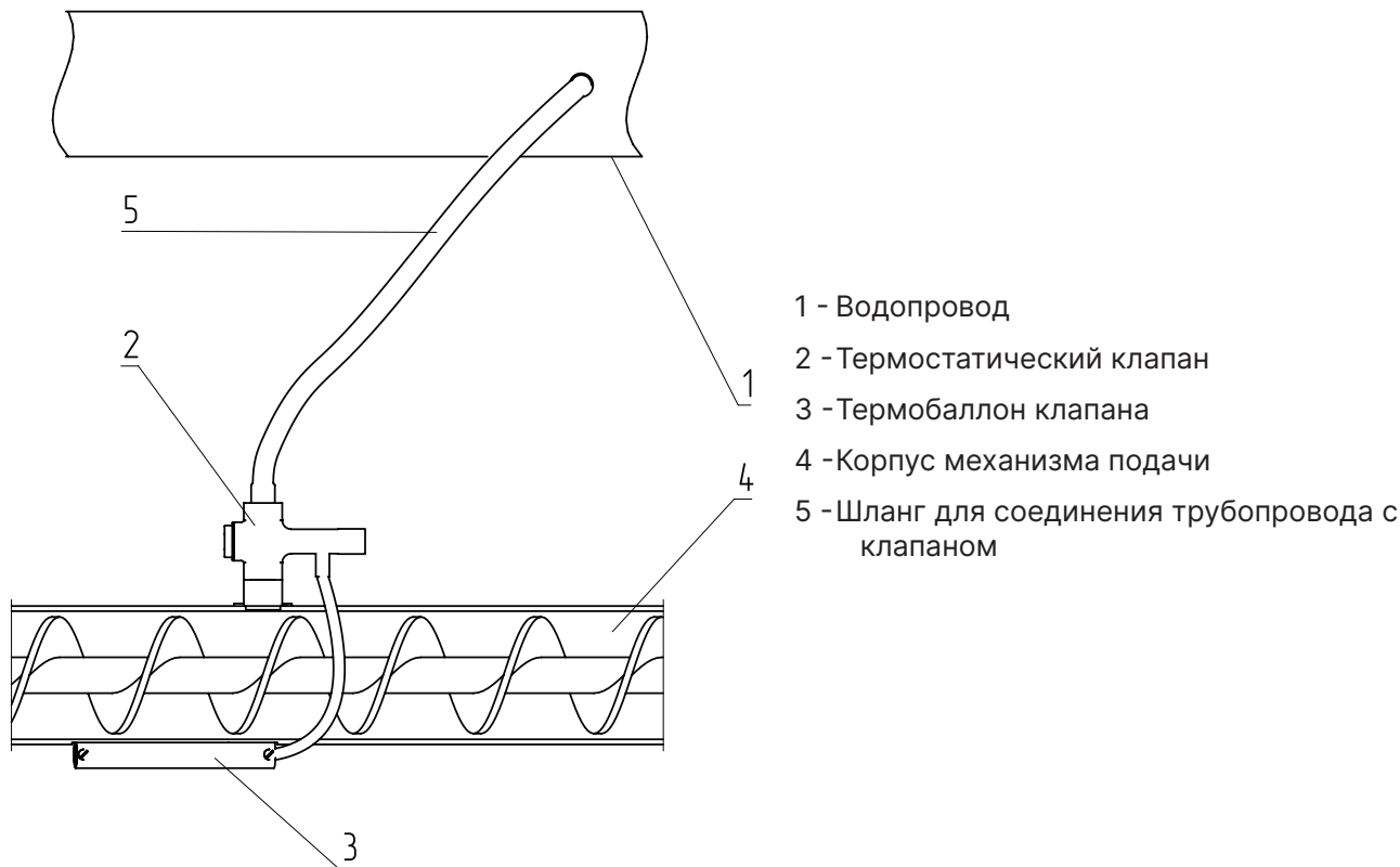
Рис.6 Система охлаждения топливопровода
