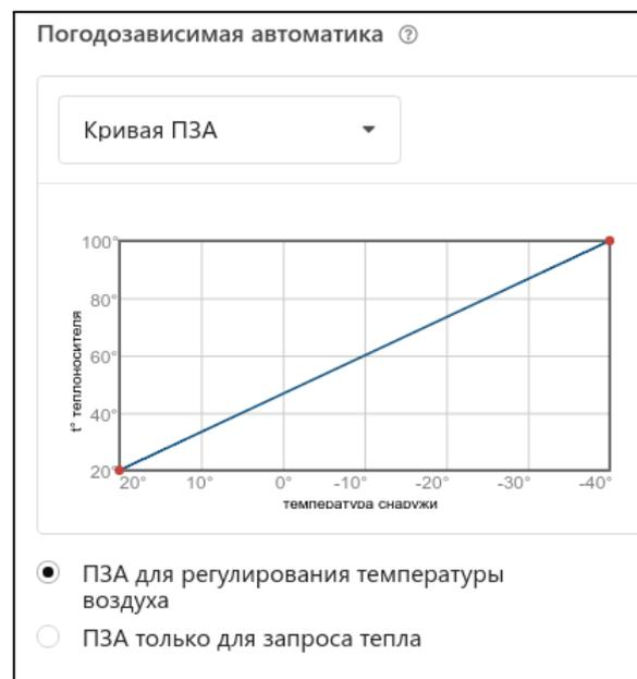
Индивидуально кривые ПЗА составляются с помощью выделения точки на графике и перетягивании ее относительно осей координат в желаемое место, или через заполнение стандартной таблицы соответствия температур улицы и теплоносителя.
