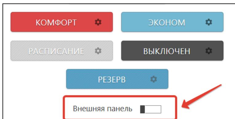
Переключение между способами управления - со штатной панели или через онлайн-сервис, выполняется выключателем на вкладке “Отопление”.
