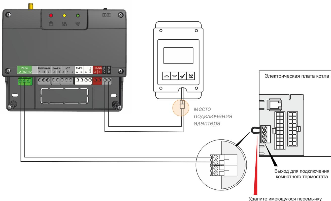
**Вариант подключения “Цифровой + Релейный” с использованием внешнего адаптера цифровых шин**
