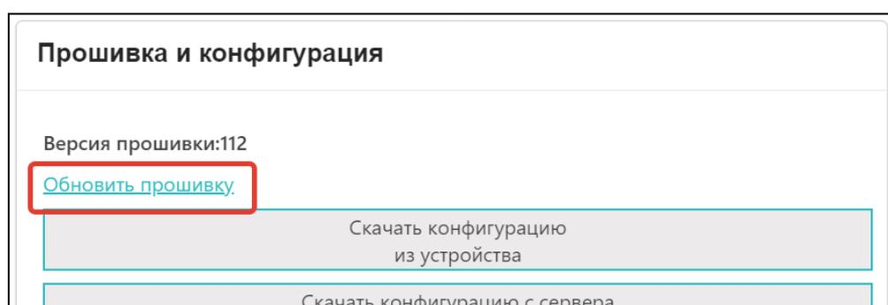
**ВНИМАНИЕ!!!** Во время обновления прошивки ни в коем случае нельзя отключать Контроллер от сети. В случае перебоев в питании и при не полностью заряженном внутреннем аккумуляторе может произойти сбой, что приведет к полной неработоспособности Контроллера. Восстановление работоспособности в этом случае возможно только в заводских условиях.
