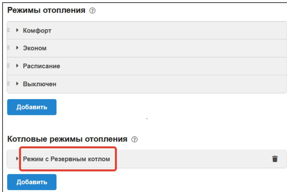
В Настройках этого режима обязательно укажите датчик, по которому контролируется фактическая температура подачи от Основного и Резервного котлов (датчик в гидрострелке) и будет приниматься решение об остановке (аварии) основного котла и необходимости включения резервного.
