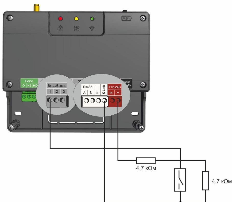
Если значение напряжения на контроллере “+12 В”; то для расчета пороговых значений напряжения и определения факта срабатывания используется следующий алгоритм:
