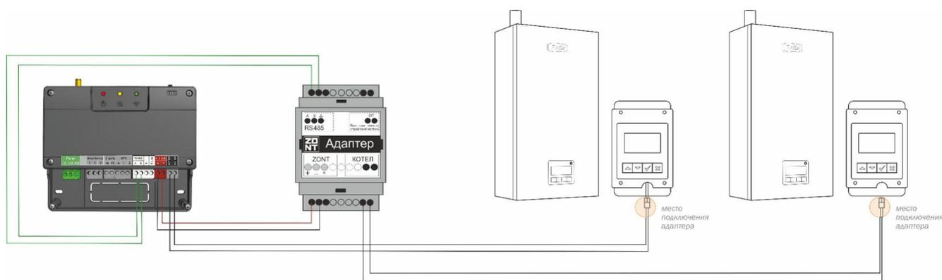
Контроллер, в соответствии с выбранным алгоритмом управления, рассчитывает температуру теплоносителя, оптимальную для поддержания целевой температуры действующего режима отопления и передает это значение как Уставку в котел. Далее расчетную температуру теплоносителя поддерживает непосредственно электроника котла за счет штатной функции модуляции мощности.
