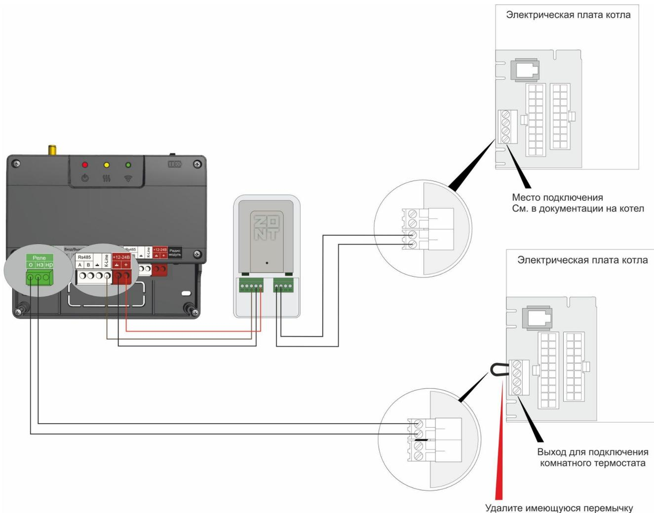
**Вариант подключения “Релейный + Релейный”**
