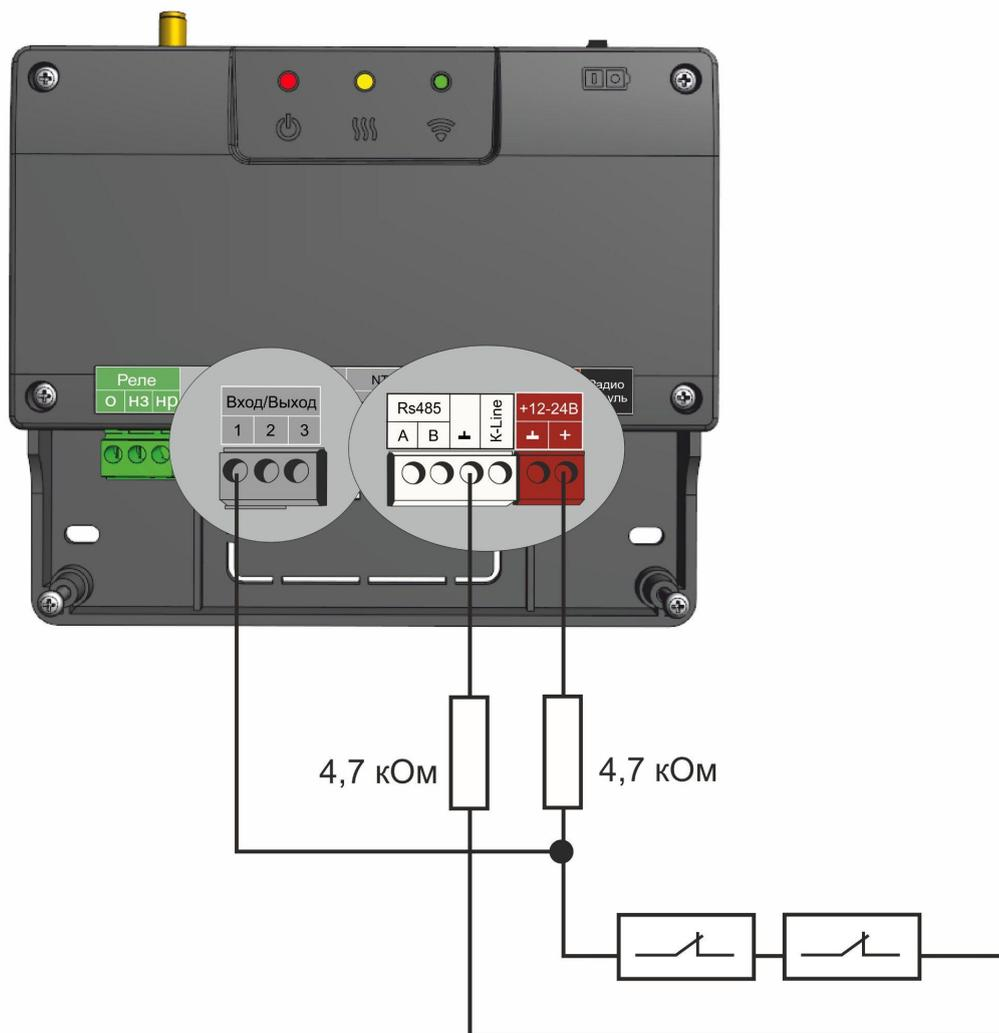
Если **значение напряжения** на контроллере **“+12 В”**; то для расчета пороговых значений напряжения и определения факта срабатывания используется следующий алгоритм:
