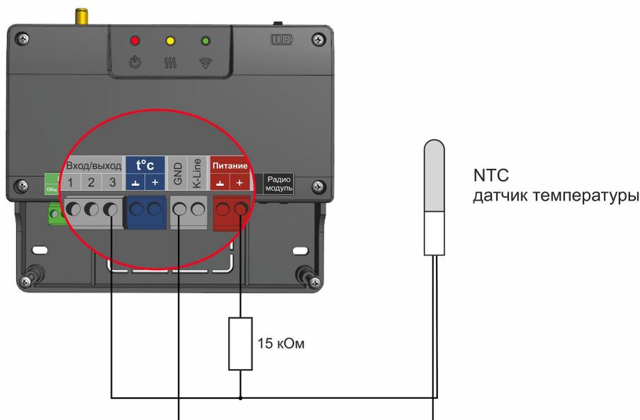
Подключение датчиков NTC следует выполнять витой парой и учитывать сопротивление провода.
