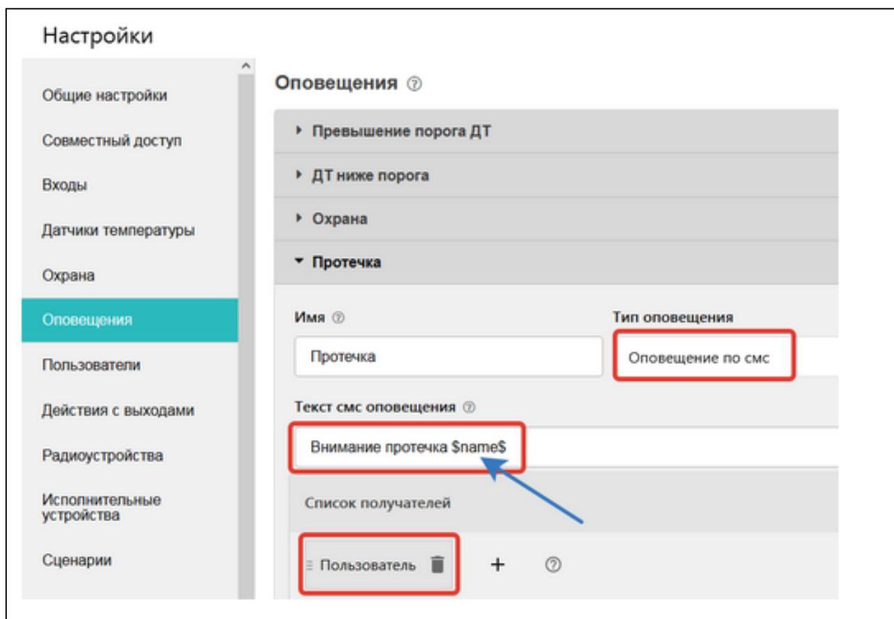
Допускается использовать типовое SMS-оповещение, применимое к разным событиям (датчикам, параметрам, пользователям).
