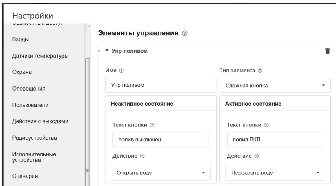
Перед созданием веб-элемента управления (кнопки) необходимо создать “действие с выходом”, которое надо выполнить. Например, требуется одним нажатием включить реле, а повторным – выключить. Тогда следует создать два “действия с выходом” – в одном реле включается, а в другом реле выключается. При этом надо использовать “Сложную кнопку”, к которой “привязываются” действия.
