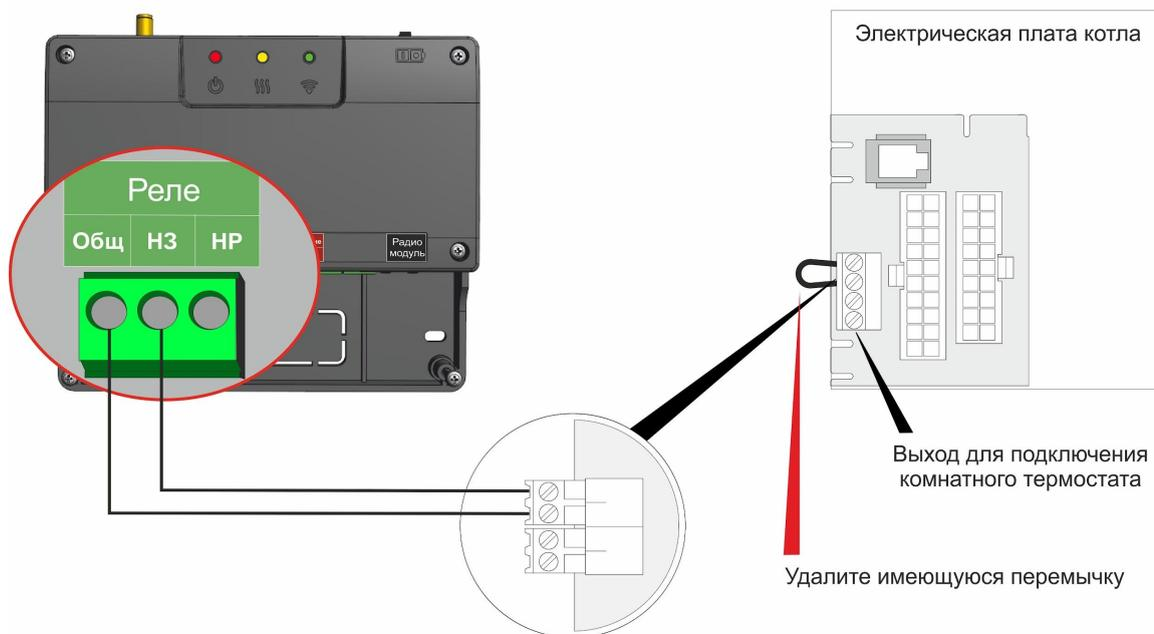
**Вариант 2:** На клеммах котла, предназначенных для подключения термостата, нет переключки и котел выключается при ее установке. В этом случае необходимо подключить подключить 1 и 3 контакты релейного выхода.
