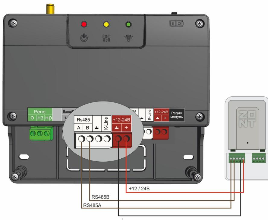
Схема подключения 2 котлов по цифровой шине: 1 котел подключается по встроенному протоколу для котлов ZOTA, второй через внешний адаптер (по интерфейсам K-Line или RS-485).
