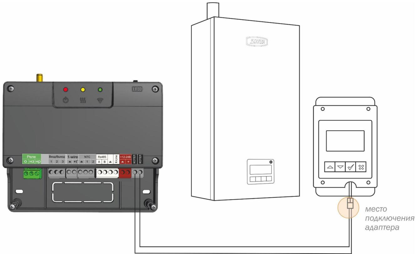
При цифровом способе управления вторым котлом (в том числе ZOTA) используется внешнее дополнительное устройство — Адаптер цифровой шины. Он подключается к Контроллеру по цифровому интерфейсу K-Line или RS-485. Допускается подключение только одного адаптера цифровой шины.
