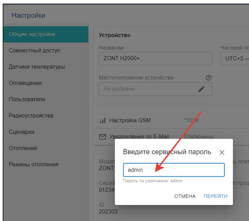
В сервисном режиме доступны настройки входов Контроллера и действий с ними, настройка исполнительных устройств и элементов управления.
