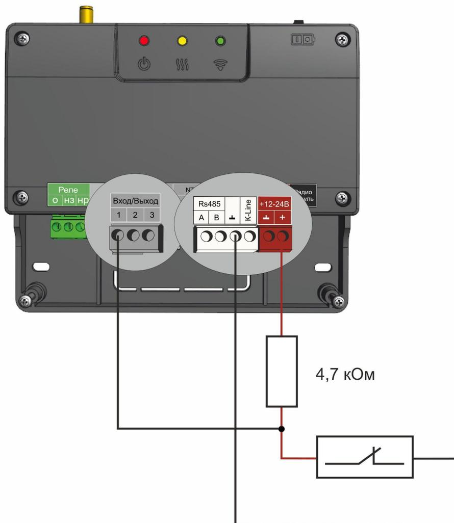
Если значение напряжения на контроллере “+12 В”; то для расчета пороговых значений напряжения и определения факта срабатывания используется следующий алгоритм:
