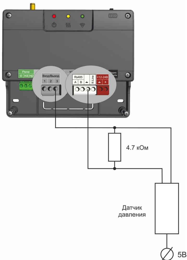
Напряжение на выходе датчика лежит в диапазоне от 0,5 В до 4,5 В.:
