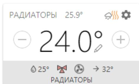
**24.0** – (в центре плашки контура) - целевое значение температуры для действующего данном контуре режима отопления. Графический элемент **"Карандаш"** – признак ввода целевой температуры в ручном режиме.
