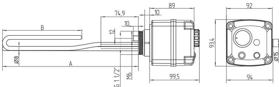
Рис. 2 Габаритные размеры ТЭН
