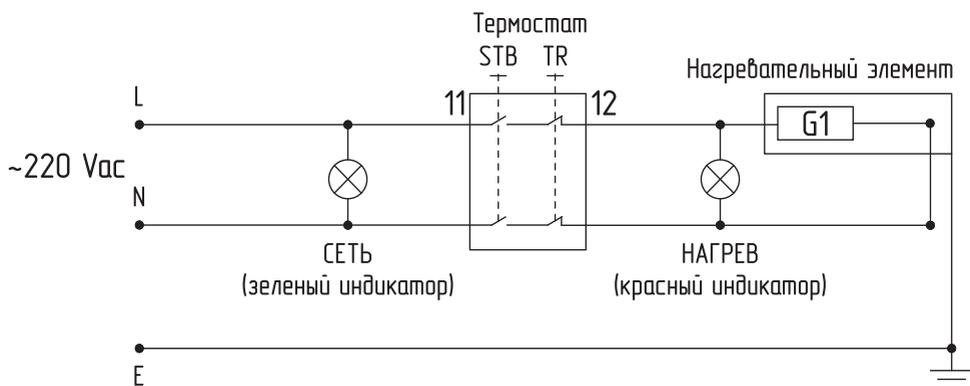
Рис. 3 Принципиальная схема подключения
