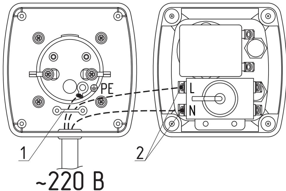
1. Фиксатор кабеля    2. Наконечники
