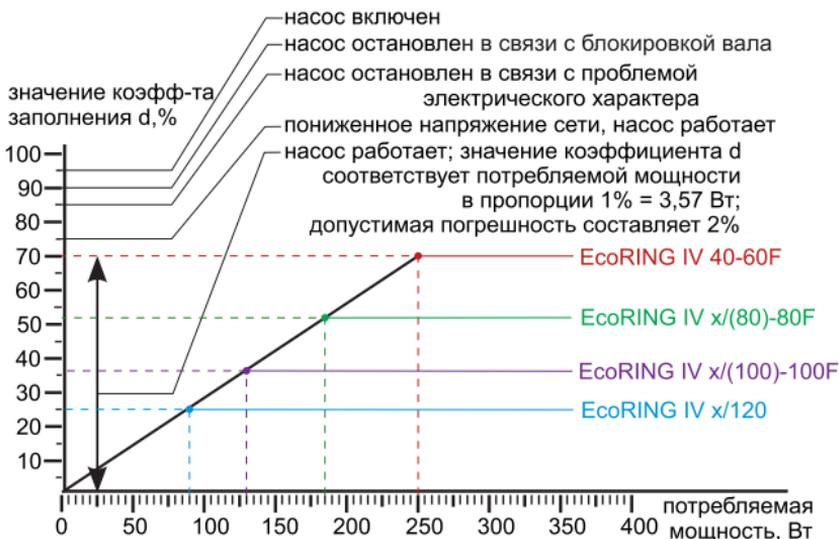
**Рис.15 Зависимость коэффициента заполнения от состояния насоса**
