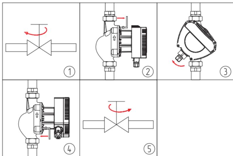
**Рис.7 Изменение положения клеммной коробки**
