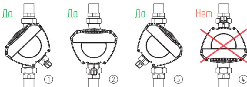
Рис.6 Положение клеммной коробки
