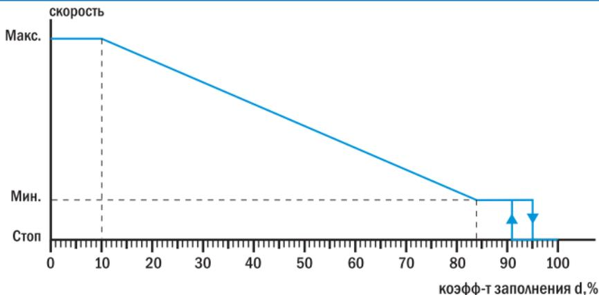
**Рис.14 Зависимость скорости от коэффициента заполнения**
