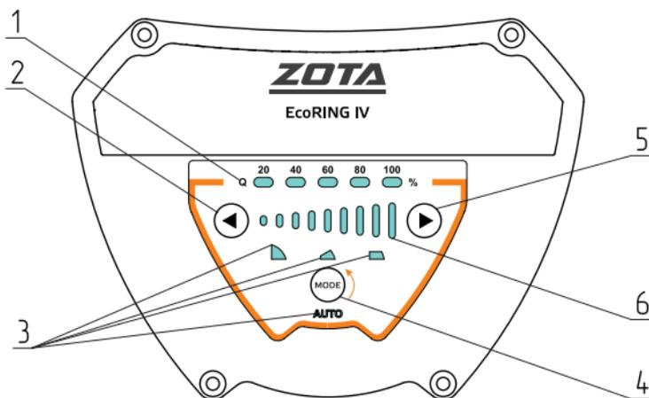
**Рис.16 Элементы панели управления**
