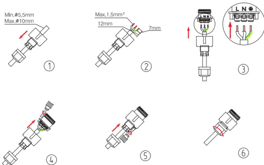
**Рис.9 Схема электроподключения**
