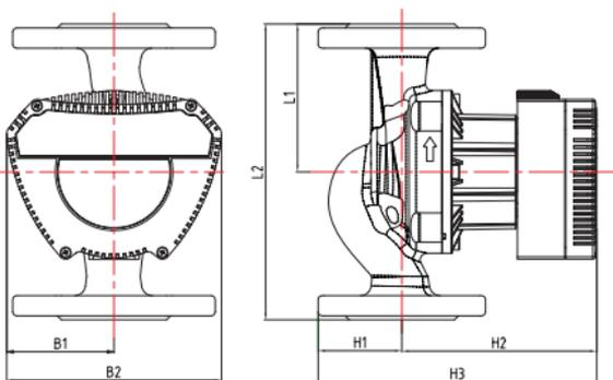
**Рис.2** Обозначение монтажных размеров насос с фланцевым соединением
