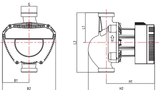
**Рис.1** Обозначение монтажных размеров насос с резьбовым соединением
