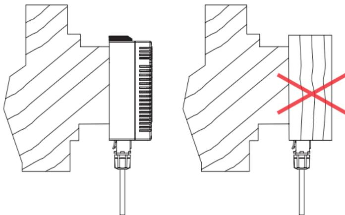
**Рис.8 Правильная термоизоляция корпуса насоса**
