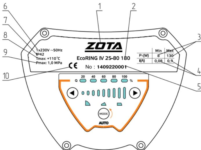
**Рис.4 Описание шильдика (таблички) насоса**
