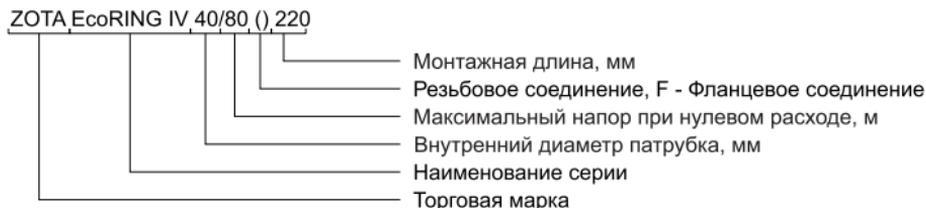
**Рис.3 Маркировка насоса**
