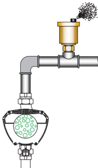
**Рис.22 Удаление воздуха из системы отопления**
