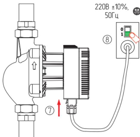
**Рис.10 Электроподключение насоса**
