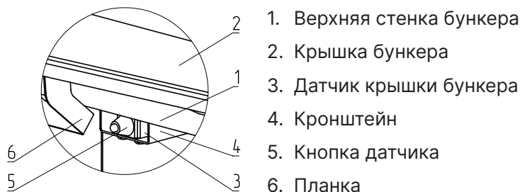
Рис.16 Установка датчика крышки бункера.
