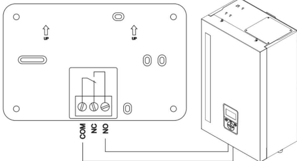
**Рис.3 Схема подключения терморегулятора**
