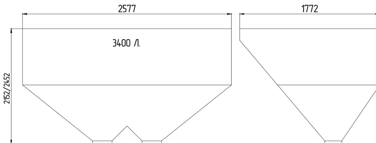
Рис.14 Габаритные размеры топливного бункера 3400 л 2 горла
