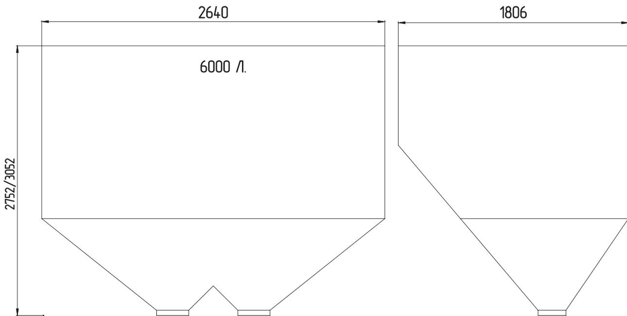
**Рис.18 Габаритные размеры топливного бункера 6000 л 2 горла**
