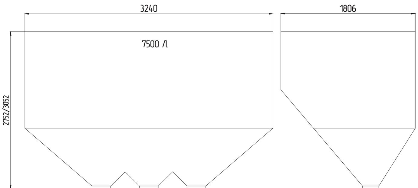
**Рис.19 Габаритные размеры топливного бункера 7500 л 3 горла**
