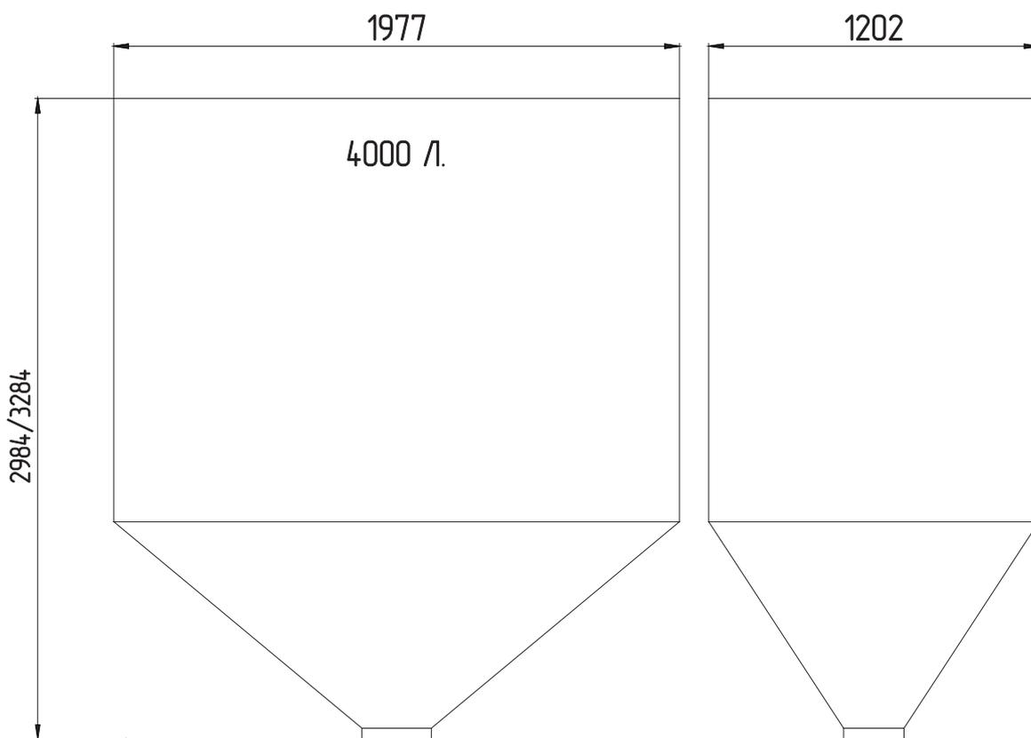
**Рис.16 Габаритные размеры топливного бункера 4000 л 1 горло**
