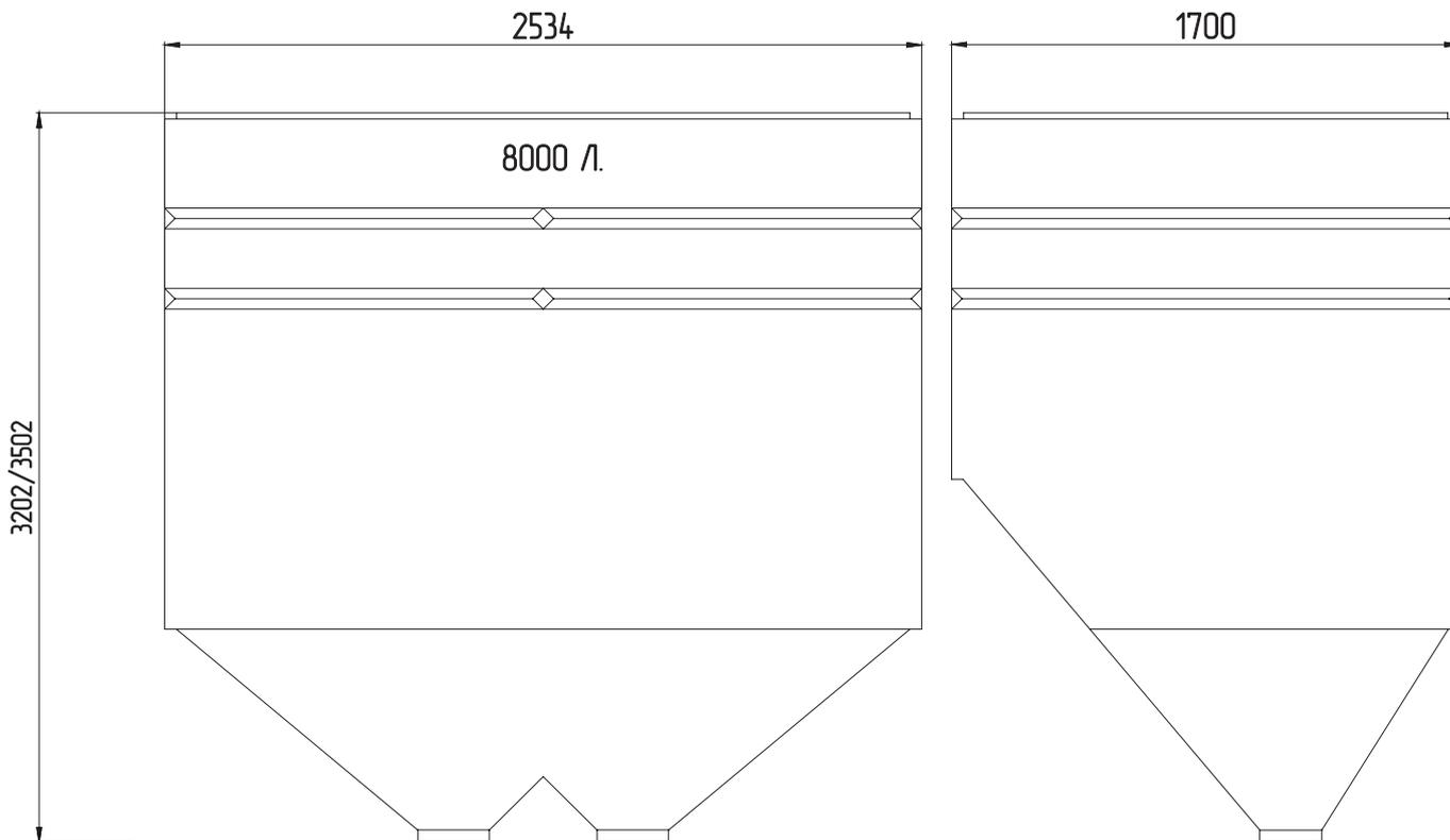
Рис.20 Габаритные размеры топливного бункера 8000 л 2 горла
