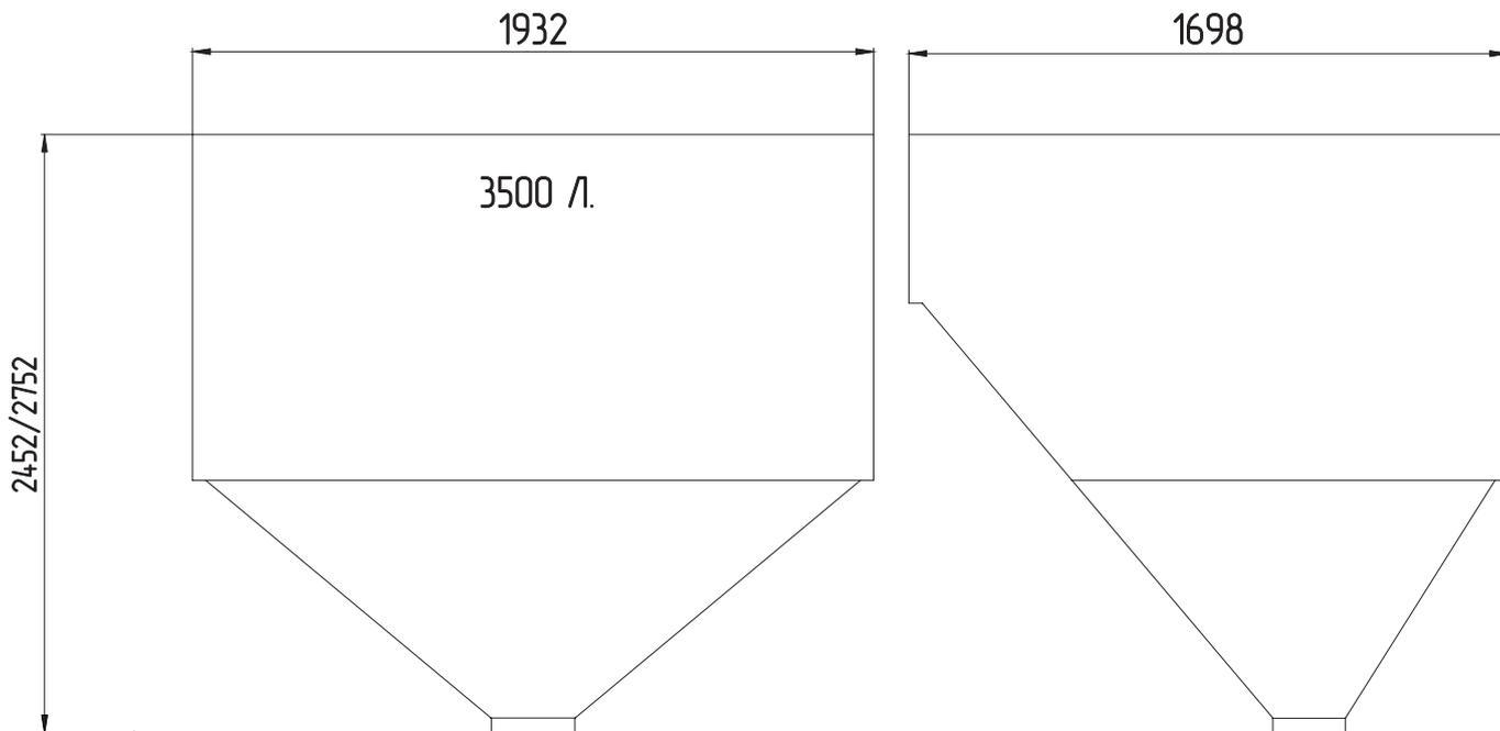
**Рис.15 Габаритные размеры топливного бункера 3500 л 1 горло**
