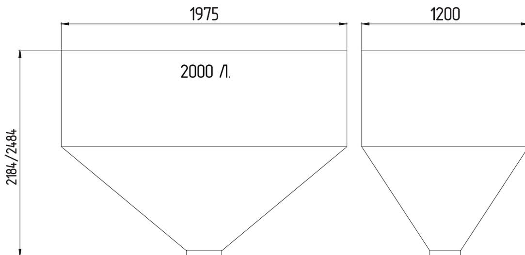
Рис.12 Габаритные размеры топливного бункера 2000 л 1 горло
