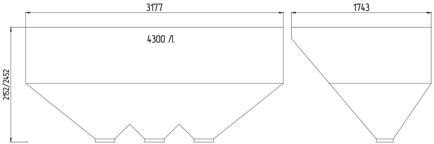
**Рис.17 Габаритные размеры топливного бункера 4300 л 3 горла**
