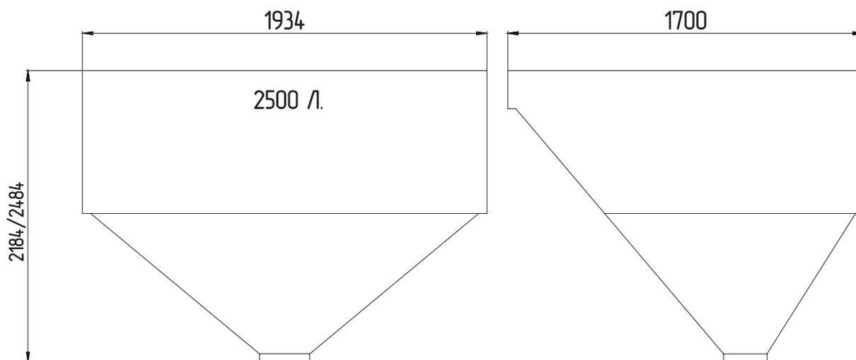
Рис.13 Габаритные размеры топливного бункера 2500 л 1 горло
