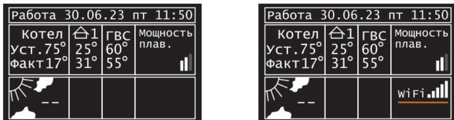
Рис.19 Проверка подключения котла к Вашей сети WiFi
