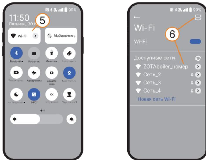
Рис.13 Подключение к сети WiFi «ZOTAb boiler»
