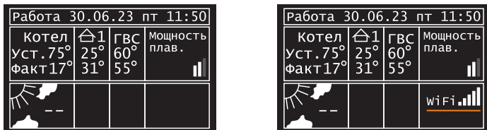
Рис.19 Проверка подключения котла к Вашей сети WiFi
