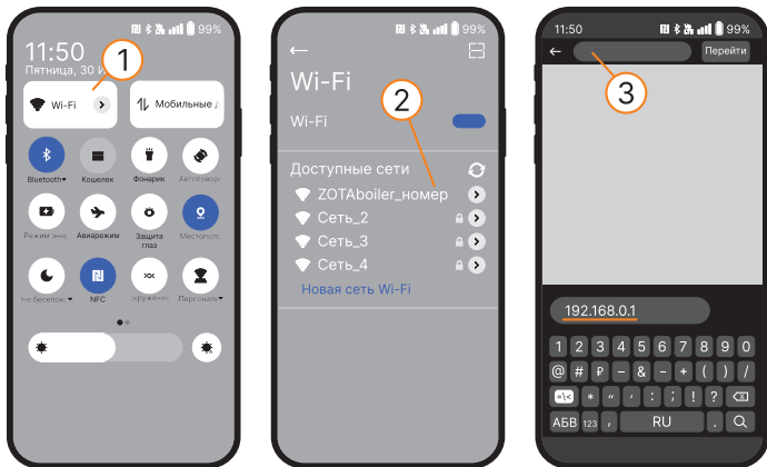
Рис.9 Подключение к сети WiFi «ZOTAbailer», ввод адреса для перехода на WEB-страницу настройки подключения
