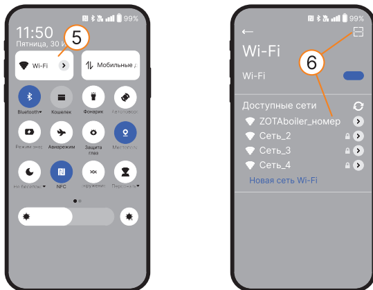
Рис.13 Подключение к сети WiFi «ZOTAb boiler»
