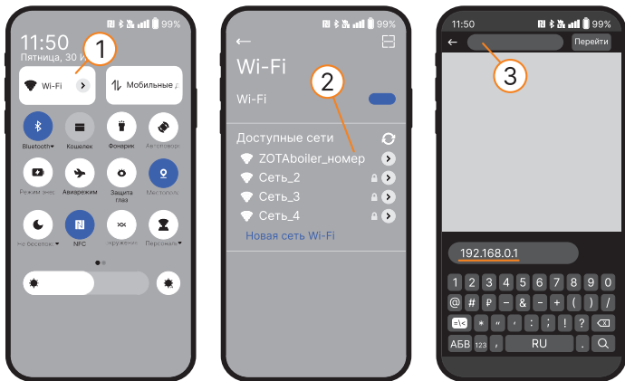
Рис.9 Подключение к сети WiFi «ZOTAb boiler», ввод адреса для перехода на WEB-страницу настройки подключения
