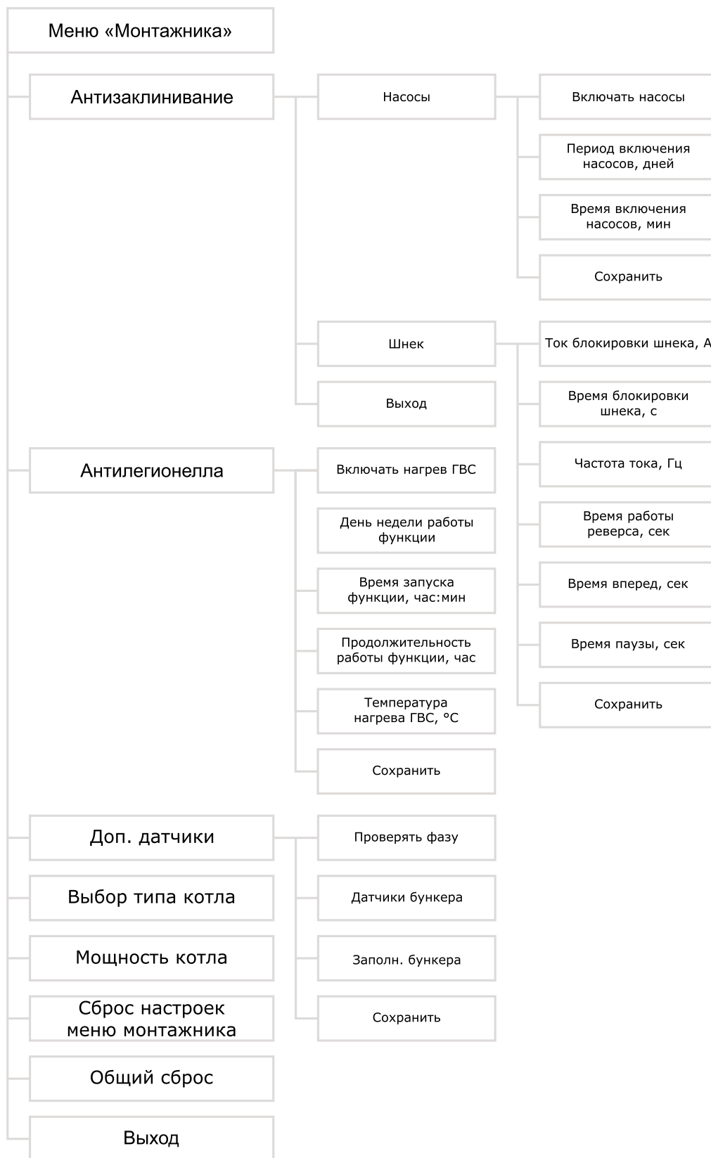
Рис.24 Блок-схема меню монтажника (продолжение)
