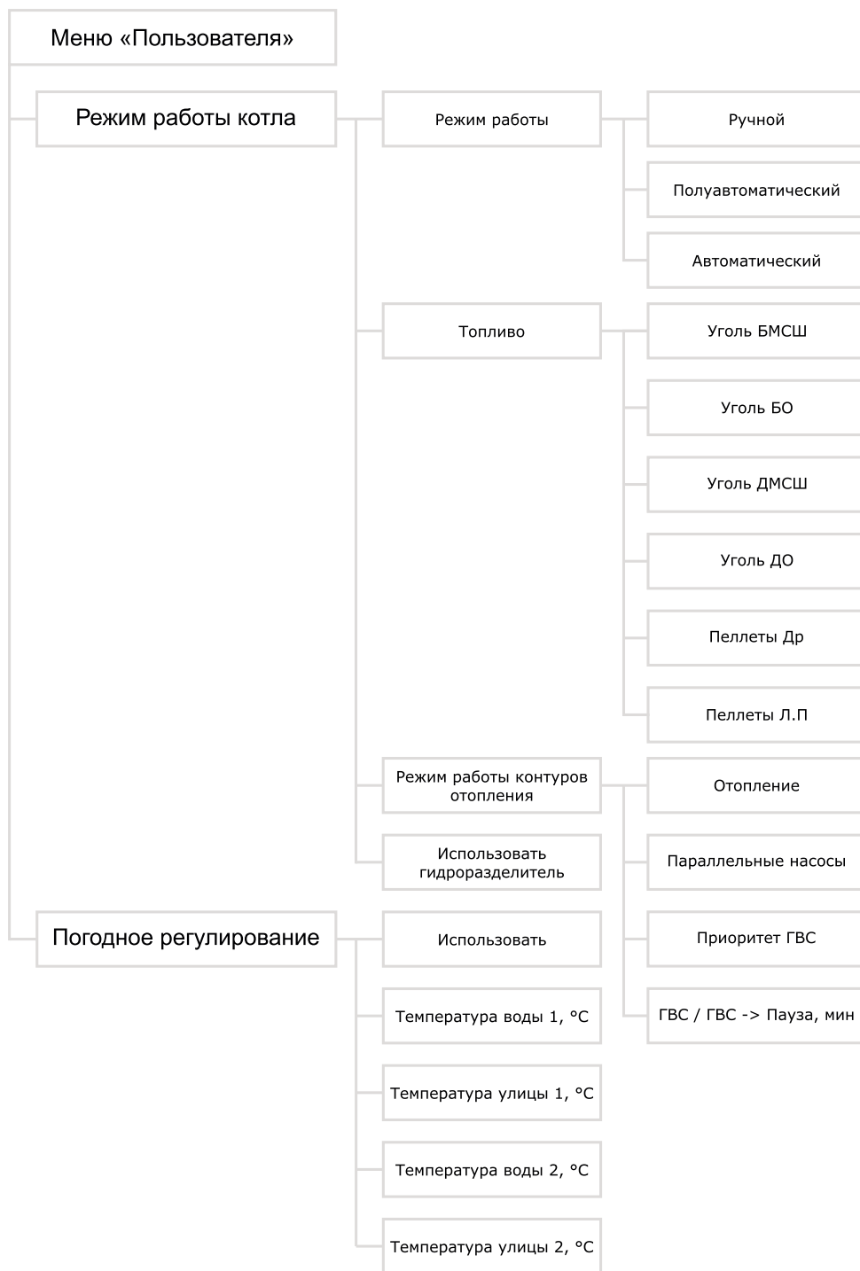
Рис.16 Блок-схема меню пользователя (продолжение)
