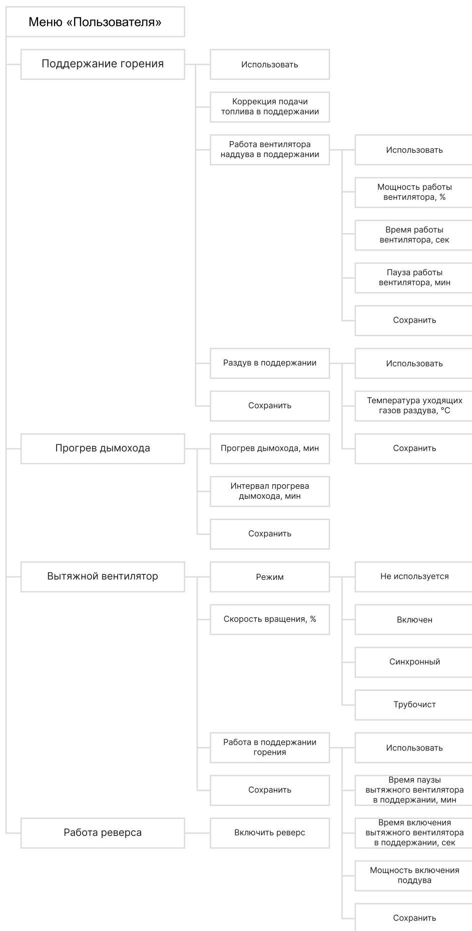
Рис.19 Блок-схема меню пользователя (продолжение)
