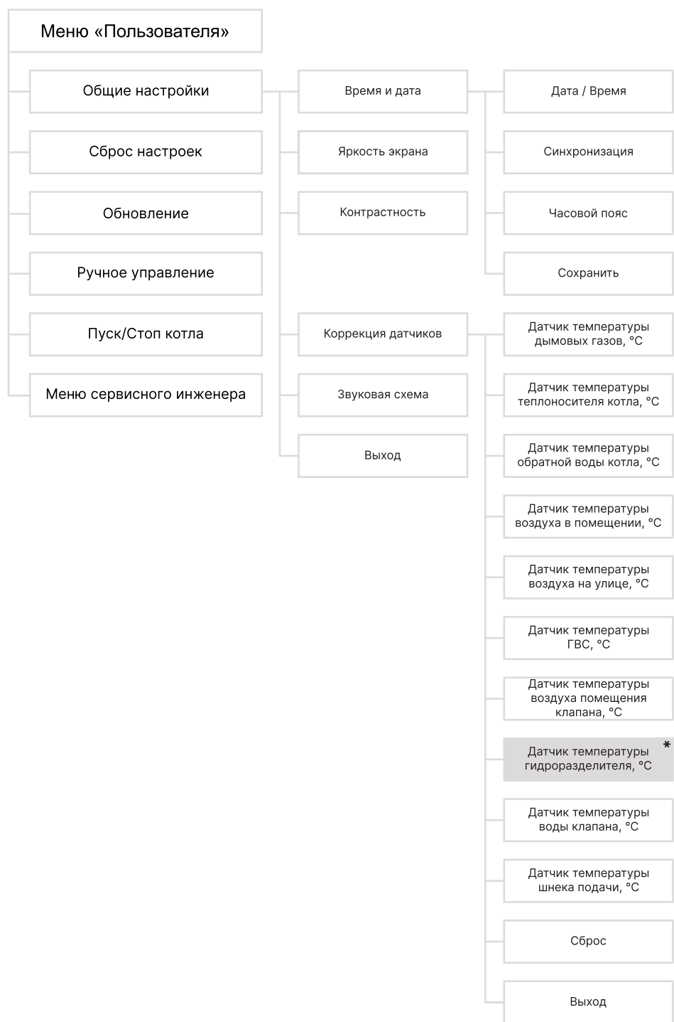
Рис.21 Блок-схема меню пользователя (продолжение)
