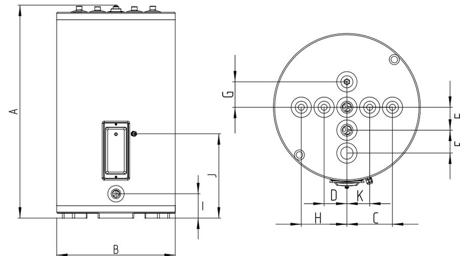
Рис.4 Габаритные размеры водонагревателя ZOTA E-HOT 150 Up
