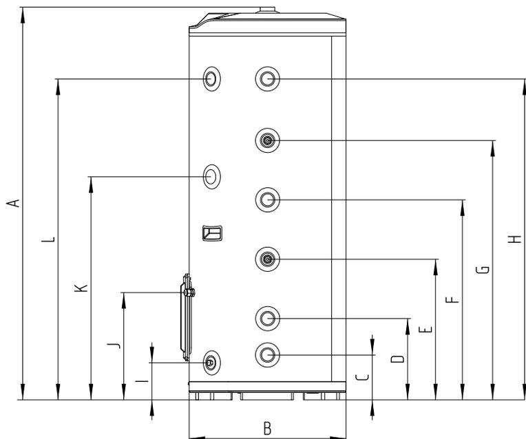
Рис.3 Габаритные размеры водонагревателей ZOTA E-HOT 150, 200, 300, 500
